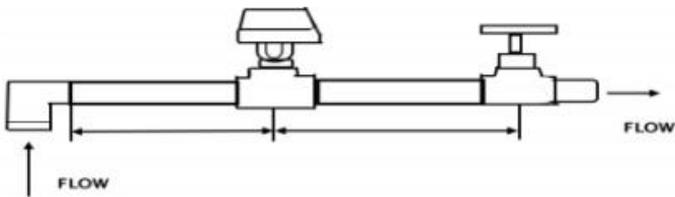
3、流量开关不能遭水击，如在流量开关下游装有快速闭合阀，必须使用节流器。
