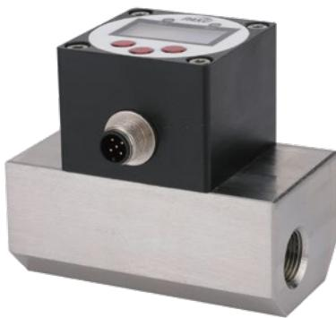
SN50D系列轮流量传感器又为一款智能流量开关,是一款精巧型流量传感器,具有体积小,设定简便等优点,内置智能电路,可任意设置流量上下限报警值,可远程监控实时流量状况,全参数现场任意设置,其叶轮测量介质通过流量通过传感器智能电路处理后任意编程。
