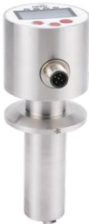
SN52H系列叶轮流速传感器又为一款智能流量、温度开关，是一款精巧型流量、温度传感器，具有体积小，设定简便等优点，内置智能电路，可任意设置流量、温度上下限报警值，可远程监控实时流量、温度状况，全参数现场任意设置，其叶轮测量介质通过流量、温度通过传感器智能电路处理后任意编程。
